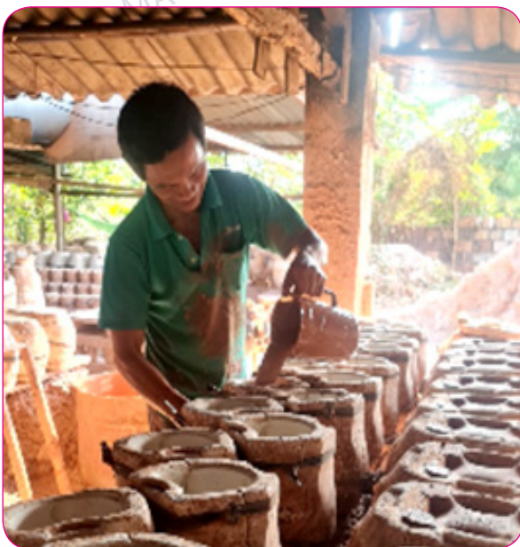
Hình 8. Tạo khuôn heo đất
