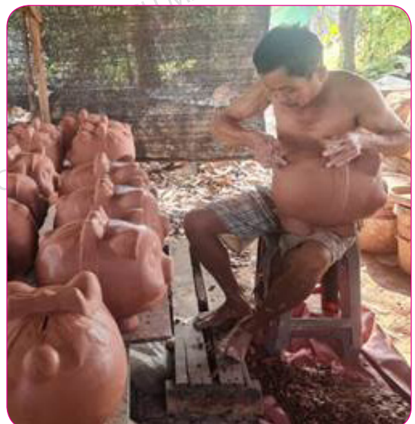
Hình 8. Tạo khuôn heo đất
